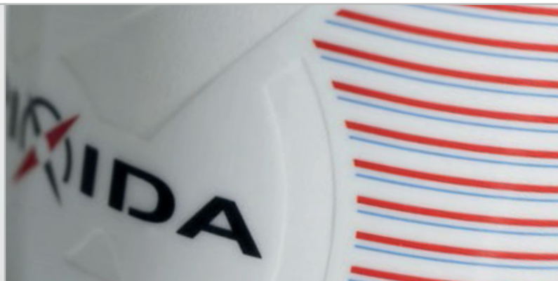
Positiv-Gravur (Verbindung von Gravur und Transferdruck) / Positive engraving (combination of engraving and print)
